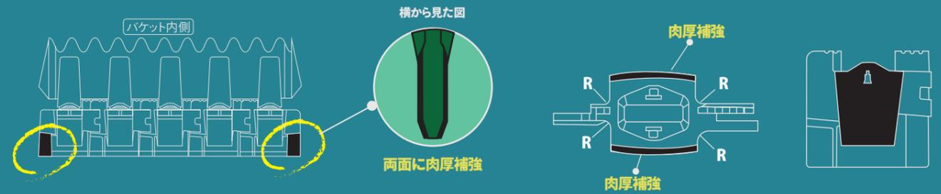
左右の角部は最も力が加わる部分で摩耗は防げない箇所ですが、肉厚補強することにより摩耗の速度を遅らせる対策を施しています。
