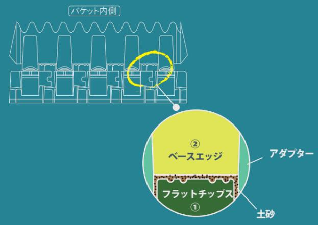
①のフラットチップスと②のベースエッジの隙間に土砂が詰まり、バケット内の土砂が抜け落ちにくくなります。
