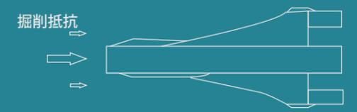
新タイプの「18s・22s」は25s～35s同様にプレート部分をツースの中心に設計しました。掘削抵抗を半減し耐摩耗に優れ、強度も肉厚補強等で強靱な構造です。
